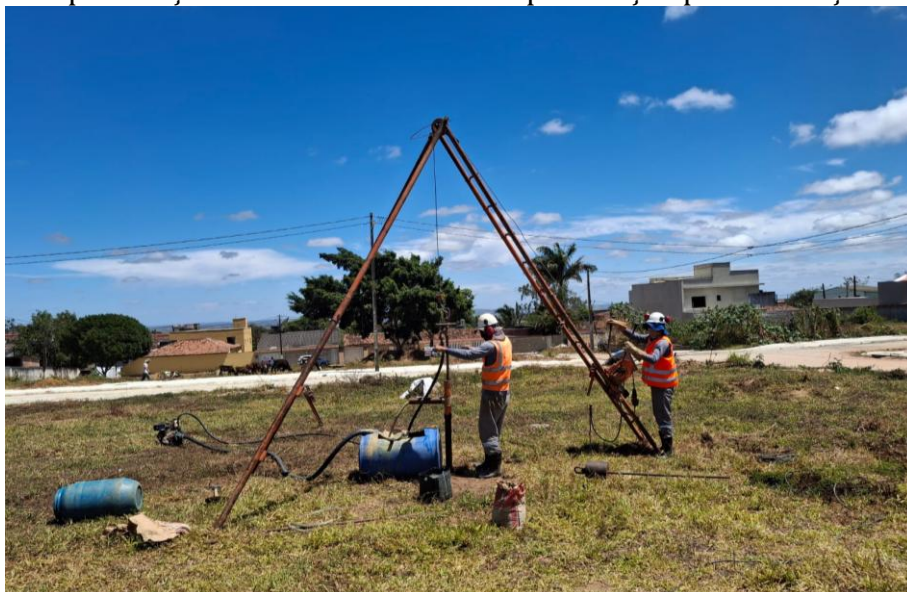
Foto 12 – Execução de sondagem de simples reconhecimento com SPT do furo SP-06, com avanço da perfuração através do método de perfuração por circulação de água.
