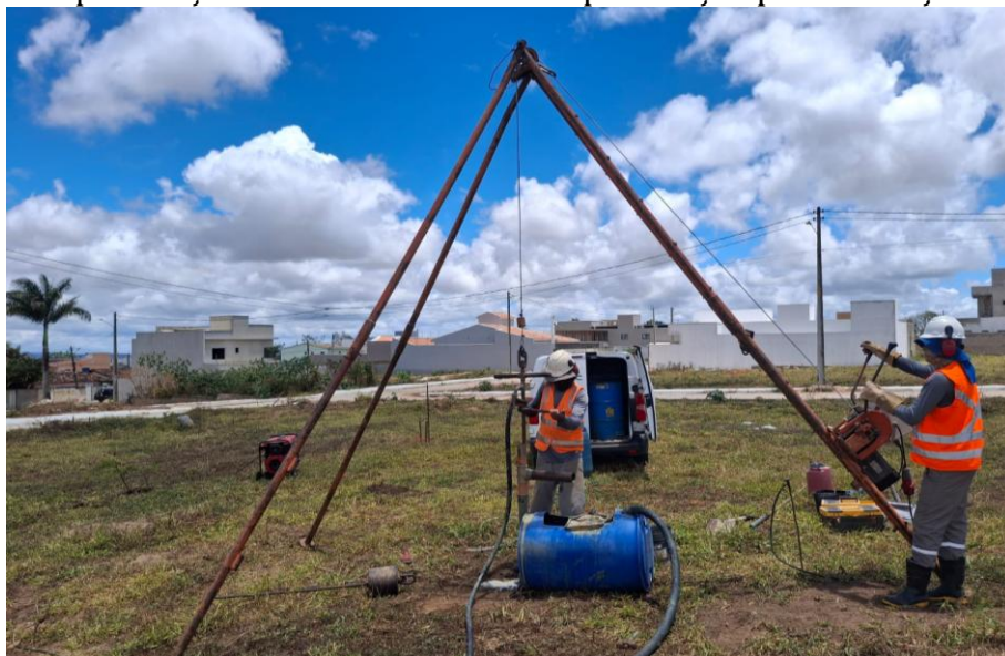
Foto 06 – Execução de sondagem de simples reconhecimento com SPT do furo SP-03, com avanço da perfuração através do método de perfuração por circulação de água.
