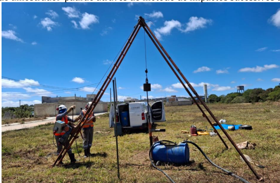
Foto 11 – Execução de sondagem de simples reconhecimento com SPT do furo SP-06, com a cravação do amostrador-padrão através do método de impactos sucessivos do martelo.
