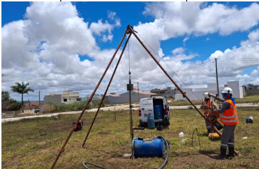
Foto 05 – Execução de sondagem de simples reconhecimento com SPT do furo SP-03, com a cravação do amostrador-padrão através do método de impactos sucessivos do martelo.
