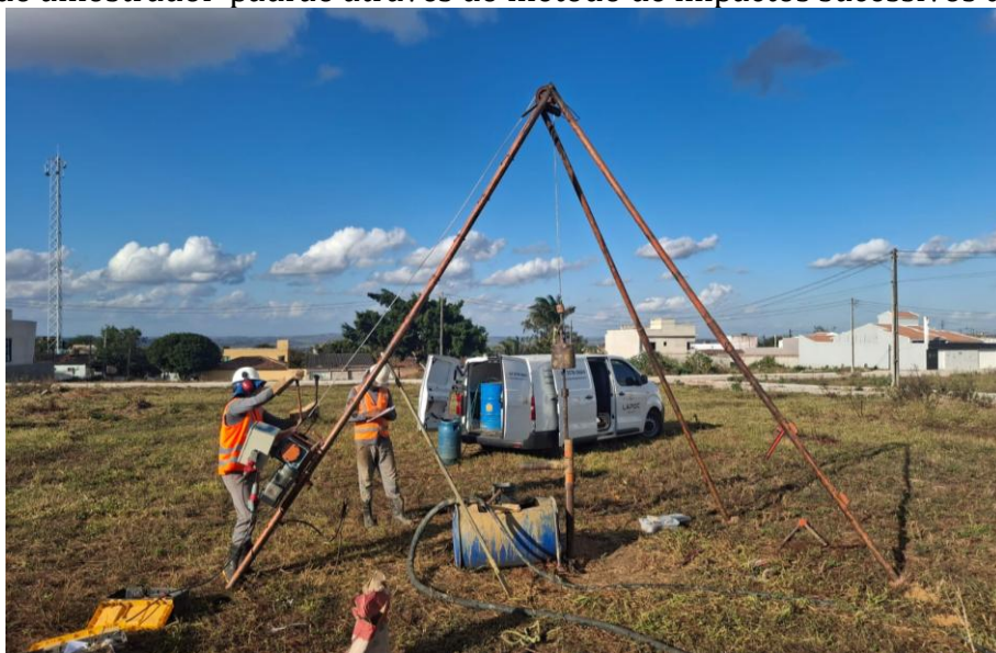
Foto 03 – Execução de sondagem de simples reconhecimento com SPT do furo SP-02, com a cravação do amostrador-padrão através do método de impactos sucessivos do martelo.
