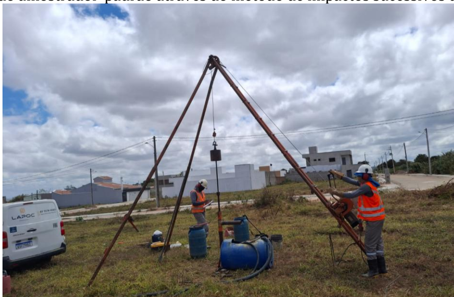
Foto 09 – Execução de sondagem de simples reconhecimento com SPT do furo SP-05, com a cravação do amostrador-padrão através do método de impactos sucessivos do martelo.
